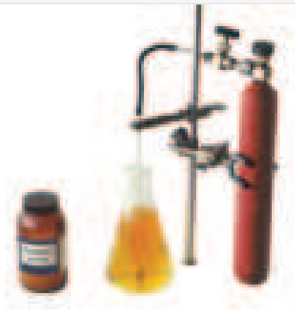
الشكل 3-2 التفاعل بين محلول أيونات البروميد وغاز الكلور هو تفاعل أكسدة، هنا تنتقل الإلكترونات من أيونات البروم إلى الكلور.
