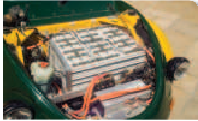
تزود بطاريات الليثيوم سيارة التجربة هذه بطاقة تجعلها تسير بسرعة قصوى بمقدارها 113 km/h قبل أن يعاد شحنها . كما أنها تستطيع السير مسافة 320 km
