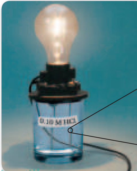
الشكل 11-2 يتوهج المصباح بقوة عندما يوضع القطبان في محلول حمض الهيدروكلوريك بتركيز 0.10\text{ M} ؛ لأن جميع HCl تتحلل إلى أيونات هيدرونيوم وأيونات كلوريد.
