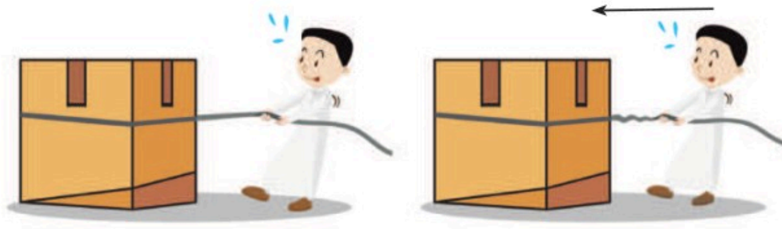
الشكل ١٦ إنحناء الحبل عند تعرضها لقوة الدفع.
