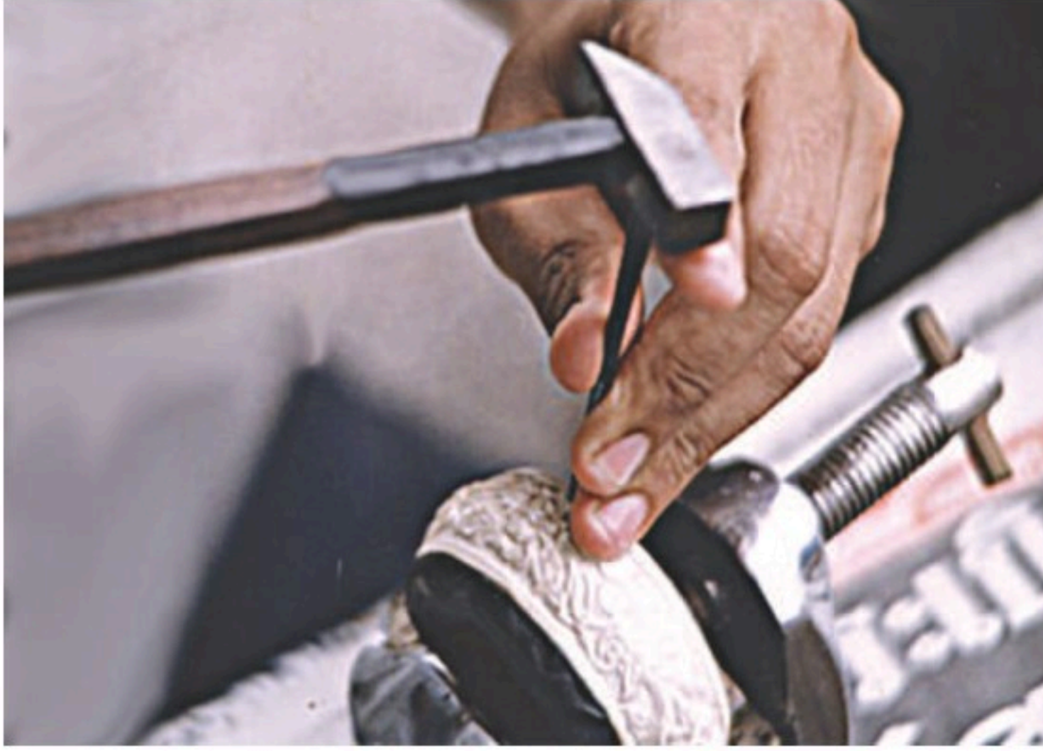
الشكل ١٢ يقوم الحرفي بالنقش على الفلز القابل للطرق للحصول على الشكل المطلوب.
