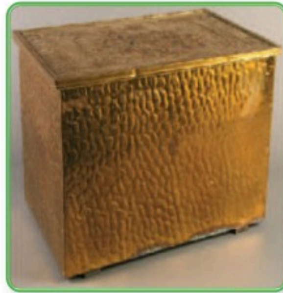
الشكل (٧٣): الطرق بالدق بالأزاميل.
