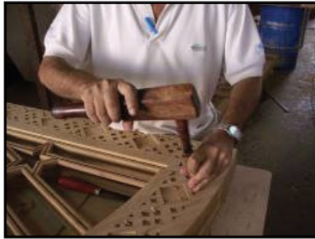
( ١ ) : استخدام المدق الخشبي ، وهي الأداة الصحيحة .
