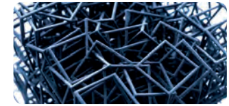
شكل 3.7: نموذج مطبوع باستخدام عملية النفت المادي
