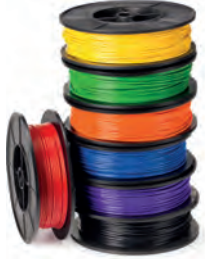
شكل 3.10: مواد بلاستيكية للطباعة ثلاثية الأبعاد
