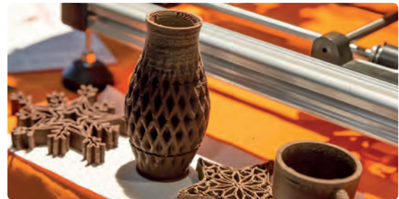
شكل 3.12: الطباعة ثلاثية الأبعاد بمادة السيراميك
