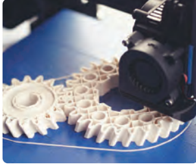
شكل 3.5: تروس تم إنتاجها بواسطة طابعة سوداء صغيرة تعمل بتقنية نمذجة الترسيب المنصهر
