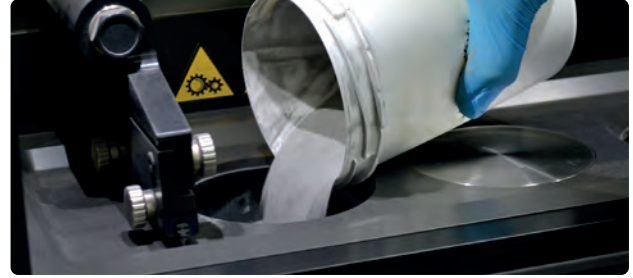
شكل 3.11: مسحوق الفولاذ المقاوم للصدأ للطباعة ثلاثية الأبعاد
