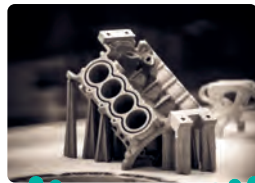
شكل 3.4: مجسّم مطبوع بواسطة آلة تليد بالليزر
