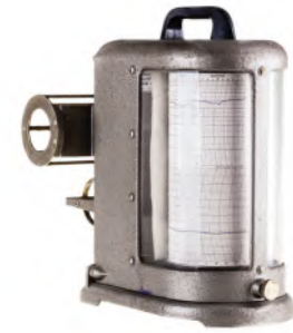
الشكل 6-20 أحد أجهزة مقياس الزلازل (السيزمومتر) الحديثة.
